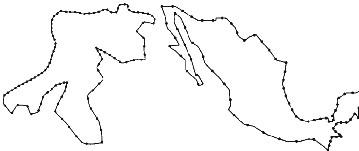
Figura 8.1: Ejemplo de distribución de puntos sobre dos contornos.
